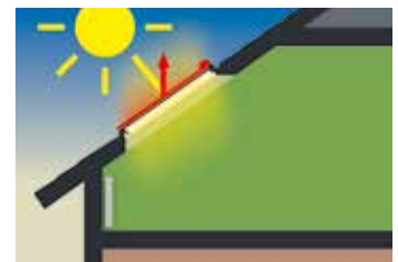
Τα εξωτερικά αξεσουάρ κρατάνε τις ακτίνες του ήλιου μακριά από τον υαλοπίνακα, μειώνουν την εισερχόμενη θερμότητα και βοηθούν στην αποφυγή της υπερθέρμανσης του δωματίου.
